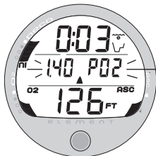
Рис. 48. Сигнал о достижении порогового значения парциального давления кислорода (установлено 1.4)
