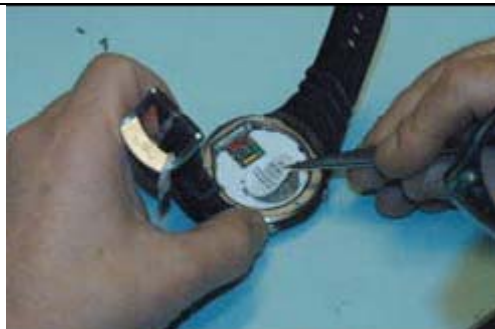
4. Используйте пинцет, чтобы удалить защитную пленку с батареи
